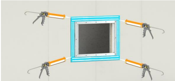
1. Applicera KD+ 2K Folielim på ramens prefabricerade foliefläns.
